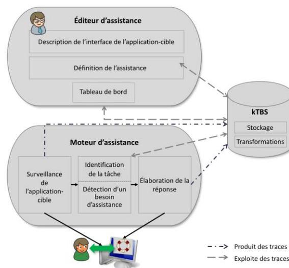
Fig. 2. Architecture du système SEPIA associé au kTBS.
