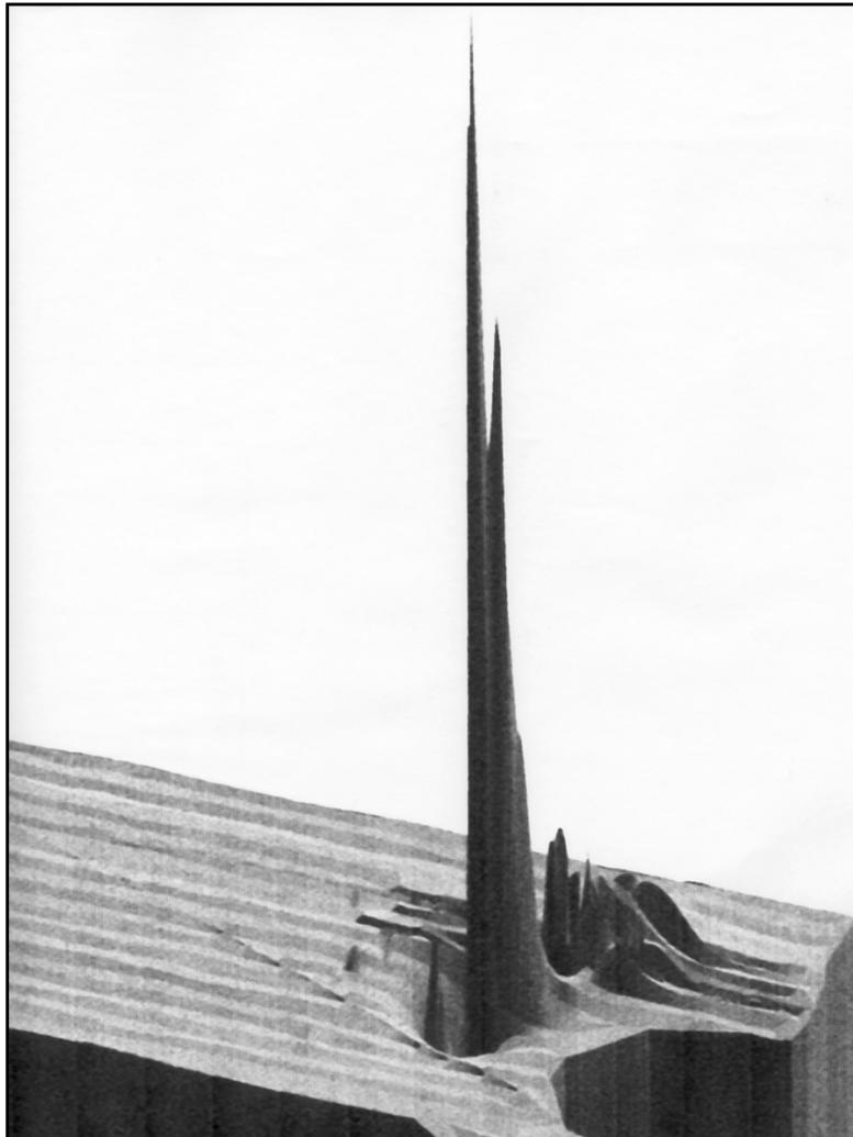
**Figure 5** - Représentation en trois dimensions d'une anomalie géologique exceptionnelle détectée en août 1999 à l'ouvert du golfe du Morbihan au large de la presqu'île de Rhuys. Pour un passage du magnétomètre à 7,5 m du fond, cette anomalie bipolaire complexe atteint à sa valeur maximale 4 242 nT. L'anomalie qui se trouve sur une faille d'orientation Nord Ouest – Sud Est, est perceptible sur une longueur de 750 m.<sup>5</sup> (GRAN/DRSM – 1999)
