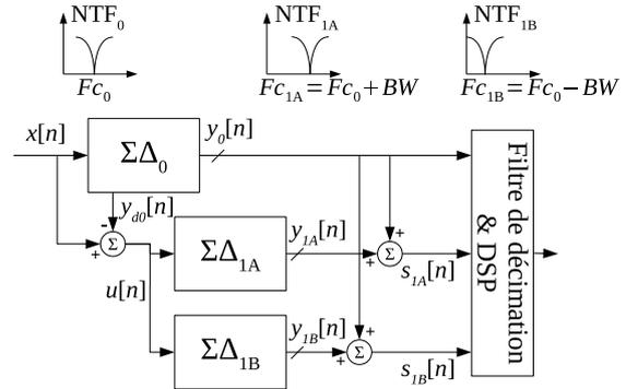
Figure 1. Architecture générale du MSNBC en temps discret
