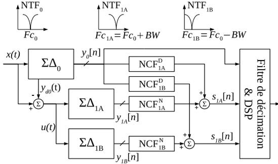
Figure 2. Architecture temps continu du modulateur principal.
