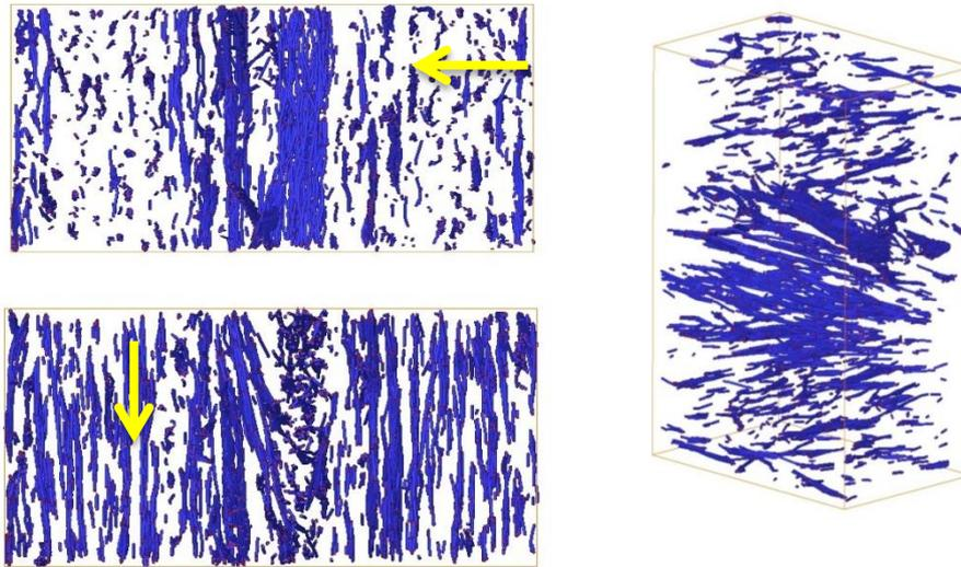
Figure 2 : visualisation de la microstructure du composite. La flèche indique la direction de l'écoulement
