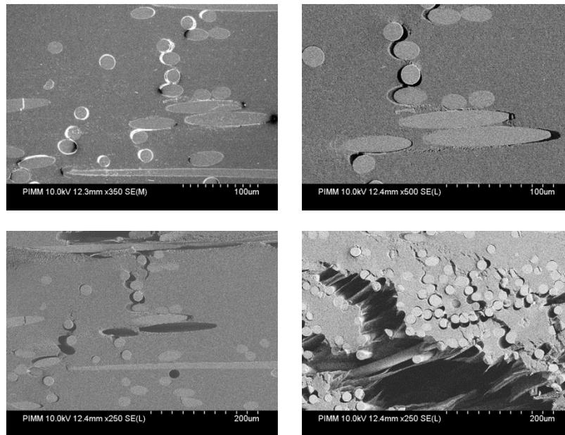
Figure 1 : mécanismes d'endommagement du composite PPGFLA0
