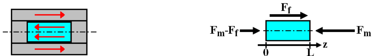
FIG. 1 – Dispositif expérimental avec sens du mouvement entre échantillon et tube (à gauche) et modèle simplifié avec définition de la coordonnée et des forces appliquées sur chacune des faces de l'échantillon (à droite).
