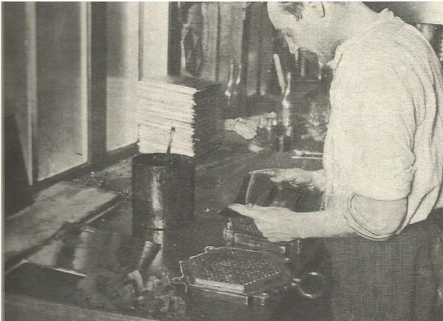
**Dépose de la plaque de gélatine supérieure**
