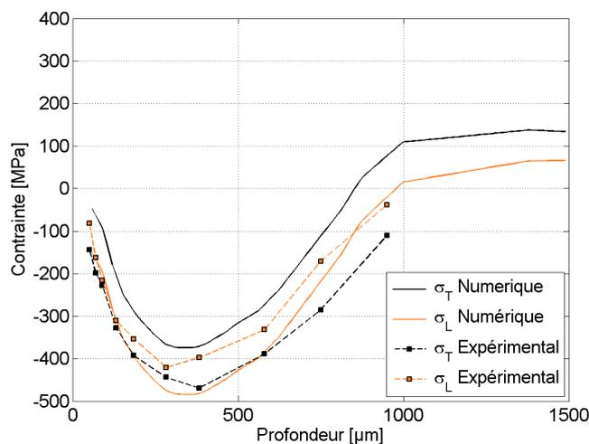
FIGURE 3 – Comparaison des contraintes de nitruration expérimentales et numériques
