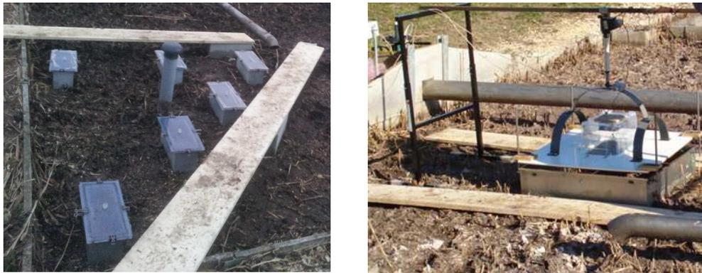
Figure 1 : Boîtes d'accumulation du gaz à prélèvement manuel (gauche) et automatique (droit) positionnées sur un filtre planté de roseaux
