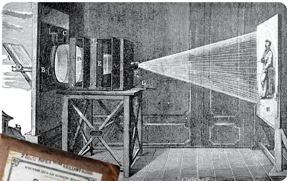
Hình 110 Máy phóng lớn nhật quang, hình chạm khắc, khoảng 1890. Những máy phóng lớn quang học đầu tiên sử dụng ánh sáng mặt trời như nguồn sáng để phóng lớn những chân dung có khuôn khổ danh thiếp.
