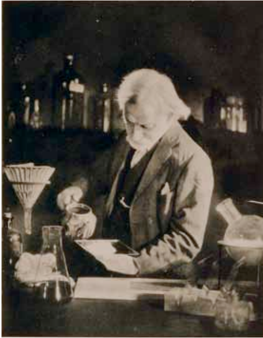
Hình 185 Nhũ tương bromua bạc keo mù được thoa quét bằng tay vào một tấm kính, nhiếp ảnh gia không rõ, khoảng 1900.
