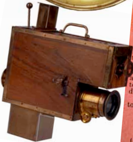
Hình 25 Thiết bị buồng tối chụp hình do F. Berneuil và Các con trai chế tạo. Thiết kế của máy chụp hình này cho phép những nhiếp ảnh viên đường phố chụp hình và tráng luôn ảnh kẽm bên trong thân của máy chụp hình.
