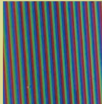
Hình 68 Photomicrograph của phim màu PolaChrome của Công ti Polaroid, 1998. Trong phim PolaChrome, sự tái thiết màu căn cứ trên sự sử dụng một màn lọc có màu, cùng theo nguyên lý được sử dụng trong những tấm phim in tự động sắc.
