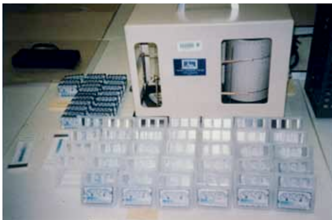
Hình 211 Máy lưu kí độ ẩm thấp và nhiệt độ (thấp nhiệt kế/ hygrothermograph) trong môi trường.
