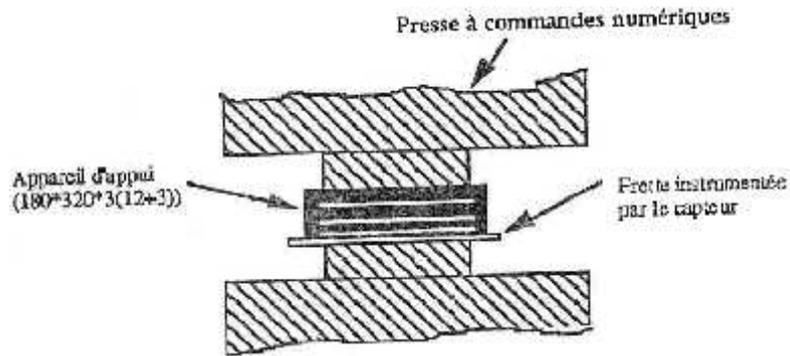
Figure 9 : Dispositif expérimental d'un essai de compression sur un appareil d'appui fretté
