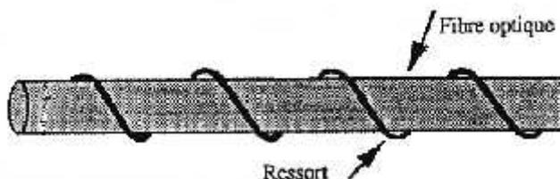
Figure 1 : Fibre optique entourée d'un ressort métallique
