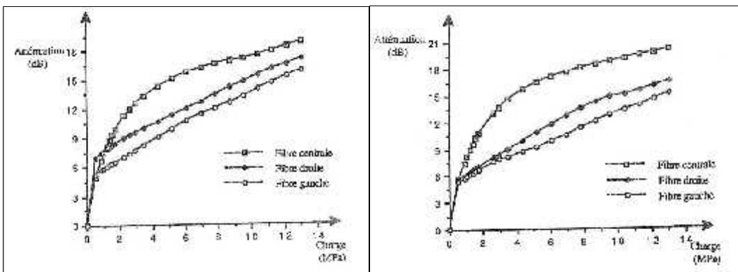
Figure 10 : Deux essais de compression simple de l'atténuation en fonction de la charge appliquée
