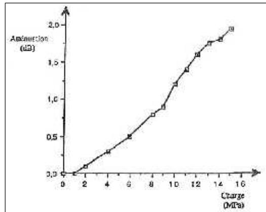
Figure 7 : Atténuation de la fibre optique en fonction de la charge de compression
