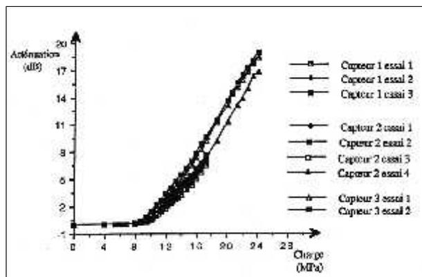
Figure 13 : Comparaison des réponses des différents capteurs en charge de compression
