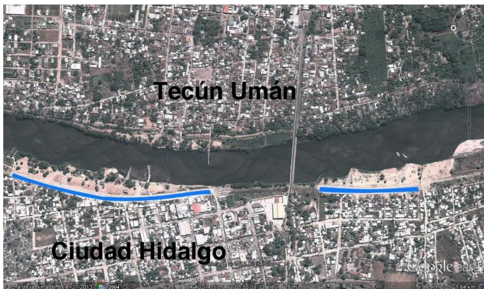
Vista en 2013 posteriormente a la construcción de los bordos de contención (en azul).
