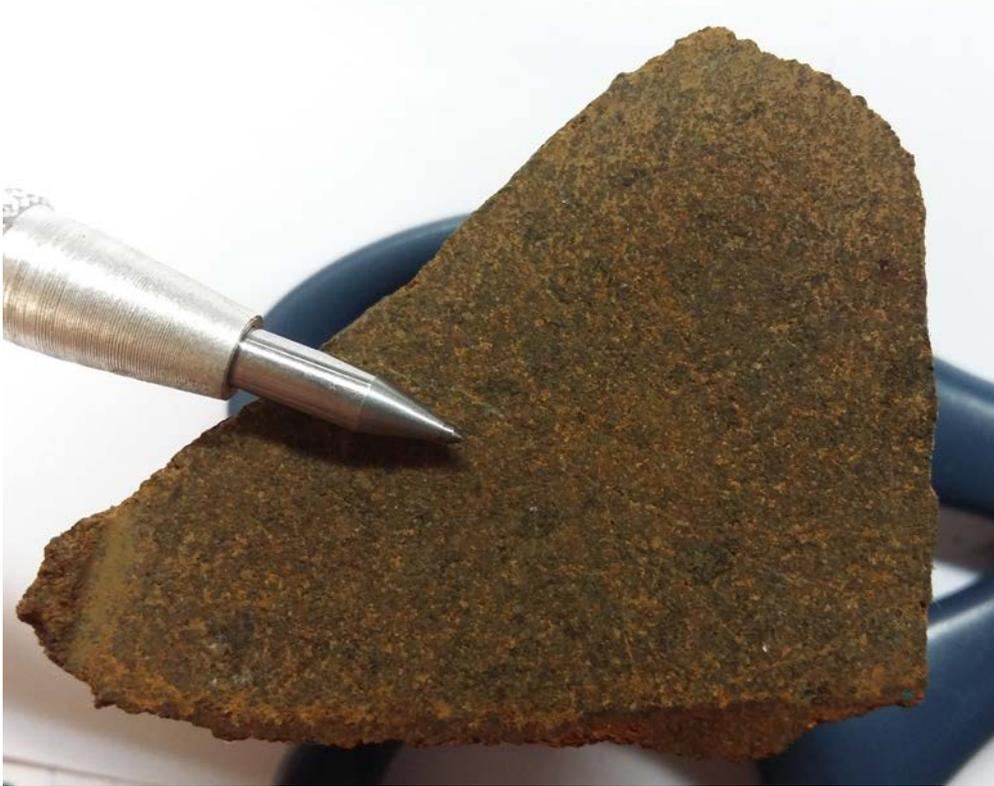
*Figure 57: section d'un claste microgrenu (DRA-E1-5) dans la brèche*
