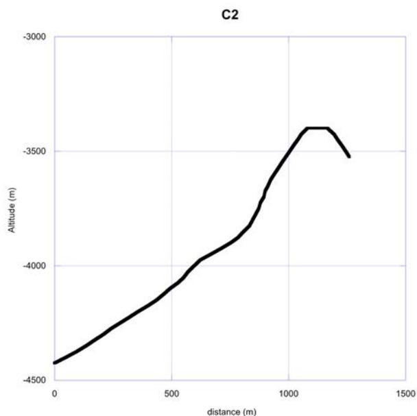
Figure 44: coupe bathymétrique prévue pour le dragage C2
