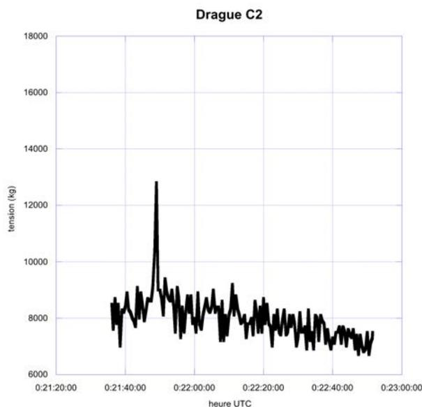
Figure 45: tension du câble pendant le dragage C2
