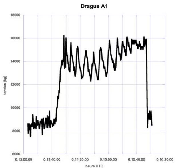
Figure 14: tension du câble pendant le dragage A1
