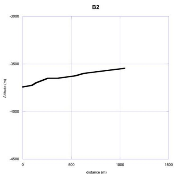
Figure 31: coupe bathymétrique prévue pour le dragage B2
