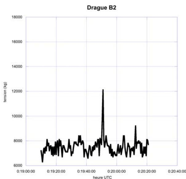
Figure 32: tension du câble pendant le dragage B2
