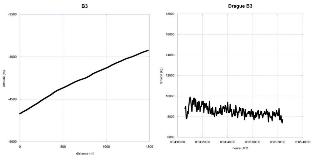
Figure 37: coupe bathymétrique prévue pour le dragage B3
