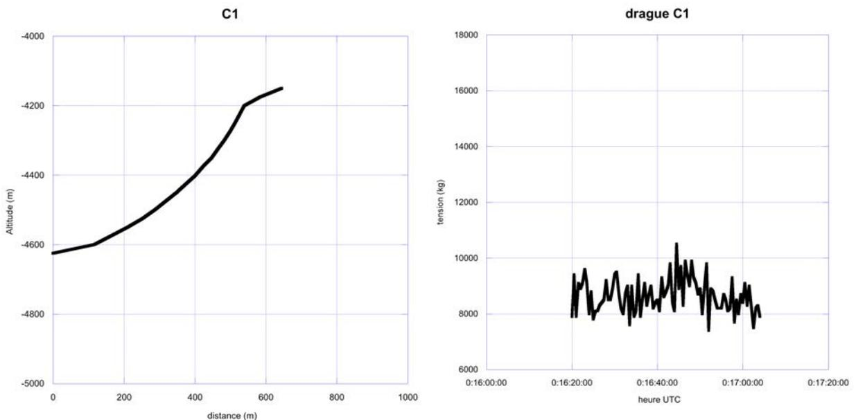
Figure 40: coupe bathymétrique prévue pour le dragage C1
