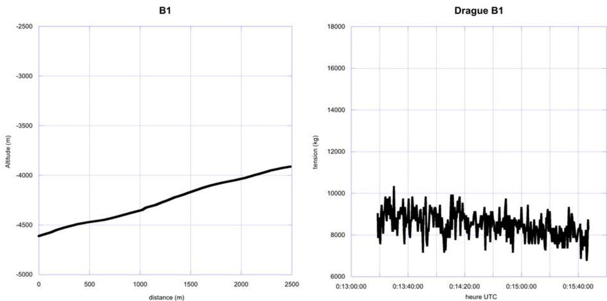
Figure 27: coupe bathymétrique prévue pour le dragage B1
