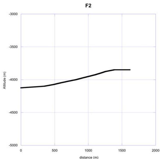
Figure 67: coupe bathymétrique prévue pour le dragage F2
