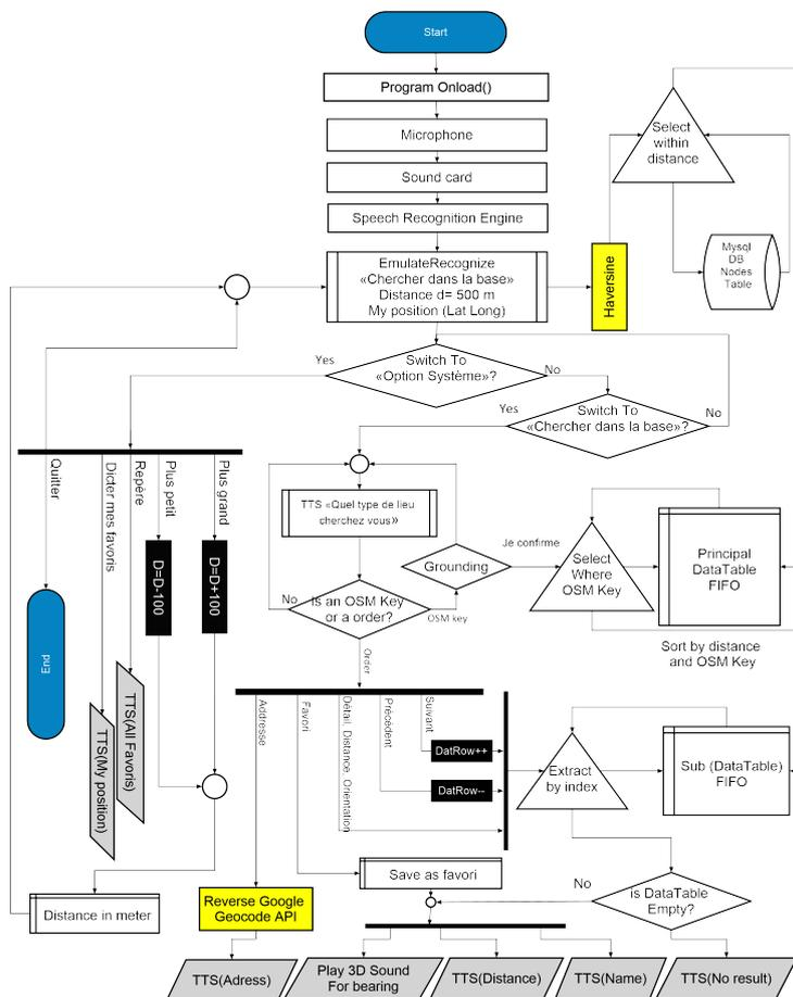
FIGURE 8. Structure de l'algorithme de transcription vocale
