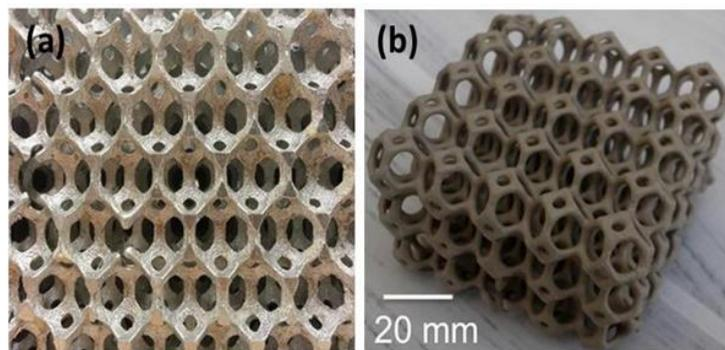
Figure 1. Présentation de la mousse métallique obtenue en utilisant (a) des processus de coulée [2], (b) l'impression 3D [3].
