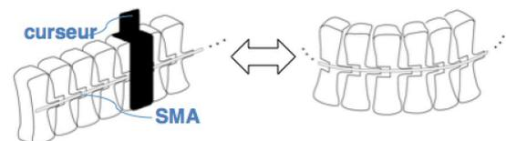
**Figure 10 : Idée n°8 (arêtes de poisson) avec SMAs. Lorsque le SMA est chauffé, la structure se plie.**
