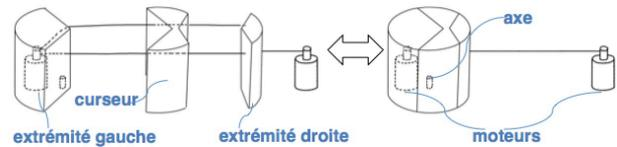
**Figure 9 : Idée n°7 (tyrolienne). Le moteur tire les câbles pour effectuer la transformation en bouton rotatif. Un autre moteur déplace l'extrémité droite pour rendre le bouton linéaire.**
