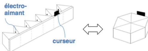
**Figure 6. Idée n°4 (Roly-poly).** Les électroaimants attirent les prismes voisins pour transformer le dispositif en bouton rotatif (droite). Quand ils changent de polarité, le dispositif repasse en forme de bouton linéaire (gauche).
