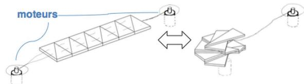
**Figure 7. Idée n°5 (origami).** Le moteur gauche tire des fils pour plier l'objet en bouton rotatif. Le moteur droit tire l'extrémité du dispositif pour le déplier en bouton linéaire.
