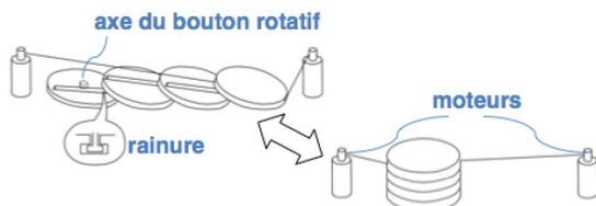
**Figure 8 : Idée n°6 (disques empilables) avec moteurs. Le moteur droit tire le disque supérieur pour former le bouton linéaire (à gauche). Le moteur gauche le tire dans l'autre sens pour reformer le bouton rotatif (à droite).**
