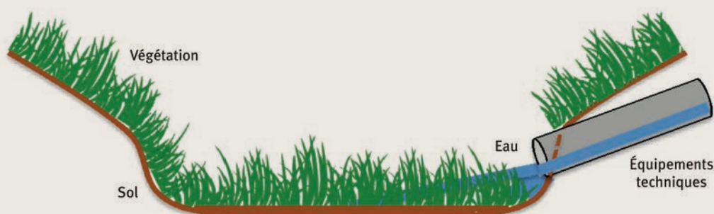
2 Illustration des différents éléments à inspecter lors d'une visite d'une technique alternative (illustration des performances des techniques alternatives – Chew et Roques, 2015)
