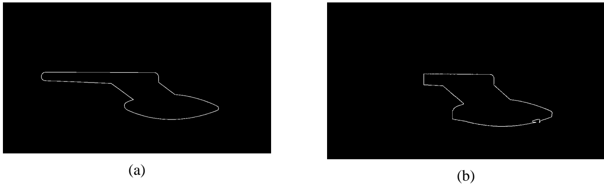
Figure 13 : (a) Contour du modèle projeté ; (b) Contour extrait dans l'image dans le cas d'une sonde cassée
