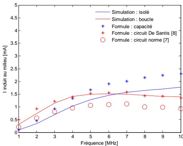
Figure 8 : Comparaison des courants induits au milieu du fantôme isolé et en boucle entre la simulation et les formules d'antenne pour un champ basse impédance
