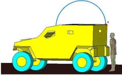
Figure 3 : Illustration d'un cas à proximité d'une antenne demi-boucle sur véhicule
