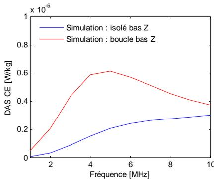
Figure 9 :  $DAS_{CE}$  dans un fantôme isolé et en boucle pour l'exposition champ basse impédance
