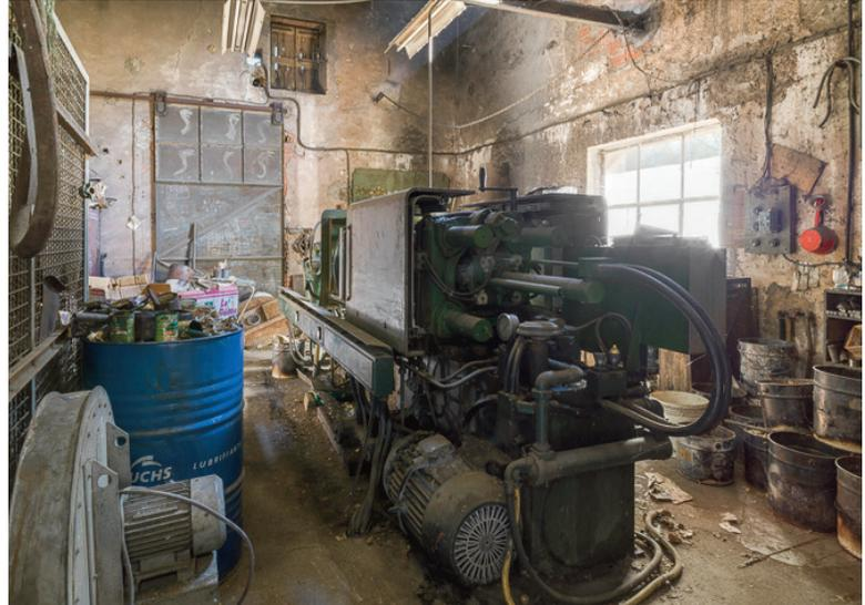
Fig. 6. Hérépian (Hérault), fonderie Granier ; presse à injection pour la fabrication des grelots de petite taille (2013). Martial Couderette © Région Languedoc-Roussillon, Inventaire général.
