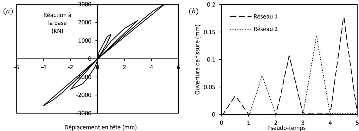
**Figure 5.** (a) Courbe réaction à la base – déplacement imposé en tête de membrane et (b) évolution de l'ouverture de fissure dans les réseaux de fissures 1 et 2 ( $-45^\circ$  et  $+45^\circ$  par rapport à l'horizontale respectivement).
