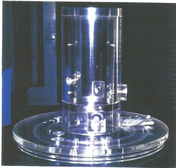
La figure ci-dessus montre une vue générale de la maquette d'essai. On distingue à droite de la tuyauterie d'aspiration, le support réglable de la sonde laser. Ci-contre est représentée une vue du couvercle supérieur de la maquette muni de logement pour les hublots en verre. La roue centrifuge Ns32 est photographiée ci-dessous avec son flasque en plexiglas poli.
