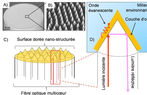
Figure 1 : A) et B) Image MEB (Microscope Electronique à Balayage) d'une fibre optique multicoeur présentant des pointes à l'une de ses extrémités ; C) Représentation d'une extrémité de fibre multicoeur nanostructurée et recouverte d'une couche d'or ; D) Représentation schématique du phénomène de SPR se produisant à la pointe d'une fibre individuelle dorée.
