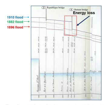
**Figure 3.** Longitudinal profile of the Doubs River within the old city of Besançon and inter-comparison of floods (sources: Ville de Besançon – Service de la voirie et des eaux: Profil en long des crues du Doubs du 21 janvier 1910, 28 décembre 1882 et 10 mars 1896, 10 mars 1910, Bibliothèque et archives municipales de Besançon, série 0). Locations of the Republique and Battant bridges are shown in Fig. 4.
