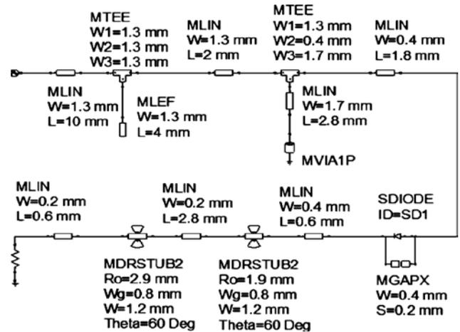
**Figure 4 : Modèle de simulation circuit (AWR) pour le redresseur haute fréquence de la rectenna Ra. [1]**
