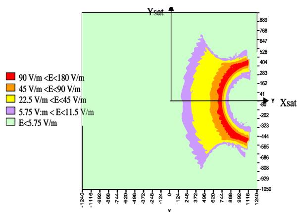
Figure 1. La cartographie du champ électrique (valeurs maximales) sur les panneaux terre d'un satellite géostationnaire ( $f=17.7\text{GHz}$ , puissance rayonnée 70 W).
