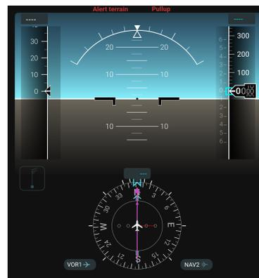
Figure 5. Le Primary Flight Display (PFD) développé
