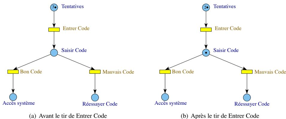
FIGURE 1 – Exemple de réseau de Petri
