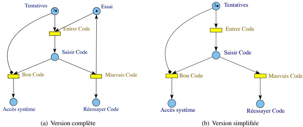
FIGURE 2 – Réseau de Petri à reset arc
