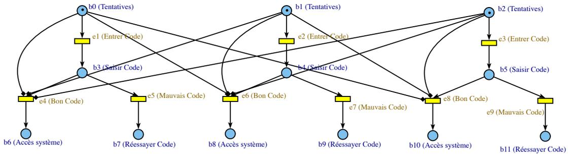
FIGURE 3 – Préfixe fini et complet du dépliage de réseau de la Figure 2(b)
