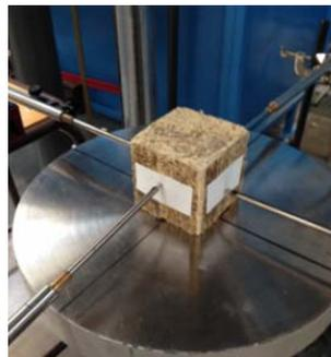
**Figure 2.** Échantillon cubique avant l'essai de compression simple.
