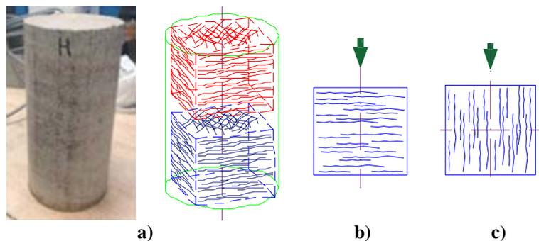
**Figure 1.** (a) échantillon cubique dans le cylindre compacté L20cm x  $\Phi$ 10cm, montrant l'orientation de la chènevotte; (b) compression simple orthogonale avec le processus de compactage; (c) compression simple parallèle avec le processus de compactage.
