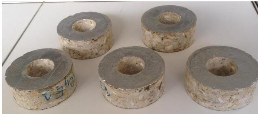
**Figure1. :** *Éprouvette de l'essai de perméabilité*
