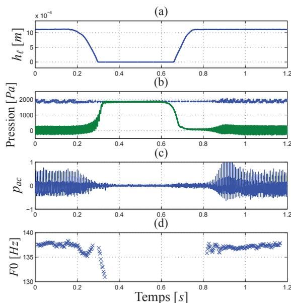
FIGURE 2 – Exemple de mesure réalisée pour  $L_p = 12$  cm. (a) : Ouverture  $h_\ell$  des lèvres mécaniques. (b) : Pressions  $P_0$  (en pointillés bleus) et  $P_1$  (en traits pleins verts). (c) : Pression acoustique  $p_{ac}$ . (d) : Évolution de la fréquence fondamentale  $F_0$  du signal  $p_{ac}$ .
