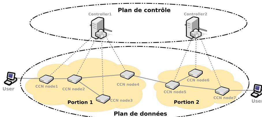
Fig. 1 – Plan de routage SDN pour architecture CCN.
