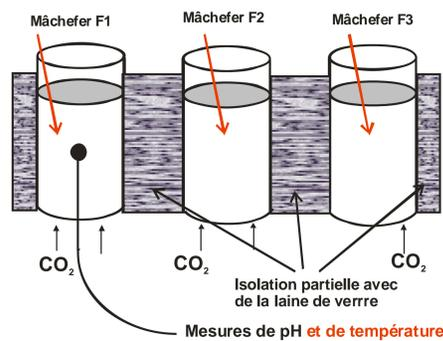
Schéma simplifié des conditions des expériences réalisées dans une salle non climatisée.
