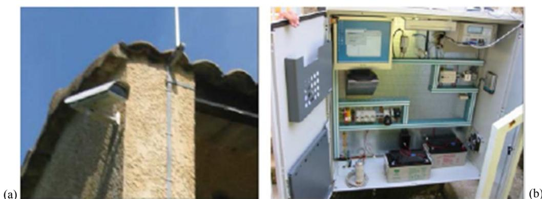
**Figure 4 :** Equipement de la station fixe de mesure LSPIV sur l'Ardèche à Sauze. (a) caméra analogique (b) caisson étanche contenant l'ordinateur et le modem.
