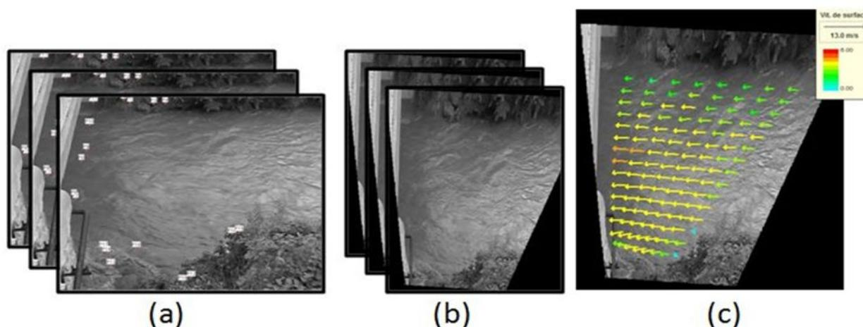
**Figure 1 :** Traitement LSPIV : (a) enregistrement d'images horodatées; (b) orthorectification des images et (c) analyse statistique du déplacement de traceurs de l'écoulement. Exemple de la station de l'Arc-en-Maurienne au pont de Randens (SPC 38) pendant la chasse de barrages de juin 2011.
