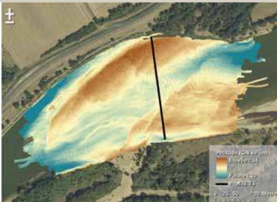
▲ Fig. 1 : Modèle d'élévation numérique obtenu par un levé bathymétrique multifaisceaux réalisé dans le secteur de Bréhémont (Indre-et-Loire). Deux barres sédimentaires (en marron) délimitées à l'aval par un front de progradation sont visibles ainsi que des dunes subaquatiques de second ordre (jaune clair). L'écoulement est orienté depuis l'Est vers l'Ouest et la droite noire correspond au profil de jaugeage solide (cf. figure 2).
