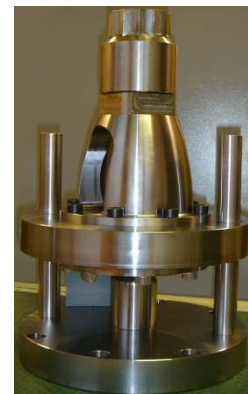
FIG.10 – Montage expérimental du test de Marciniak
