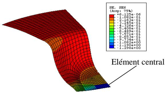
FIG.7 – Distribution de la déformation dans l'épaisseur pour l'éprouvette numéro 2 (TAB.1)
