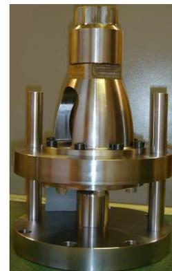
FIG.10 – Montage expérimental du test de Marciniak
