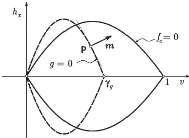
Fig. 5 – Definizione della superficie  $f=0$  e della grandezza  $\gamma_g$ .
