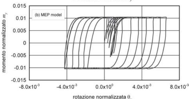
Fig. 15 – Prova di calibrazione n. 3 – fase b): momento normalizzato  $m_y$  vs. rotazione normalizzata  $\theta_y$ .
