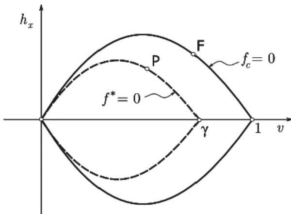
Fig. 4 – Definizione della superficie  $f=0$  e della grandezza  $\gamma$ .
