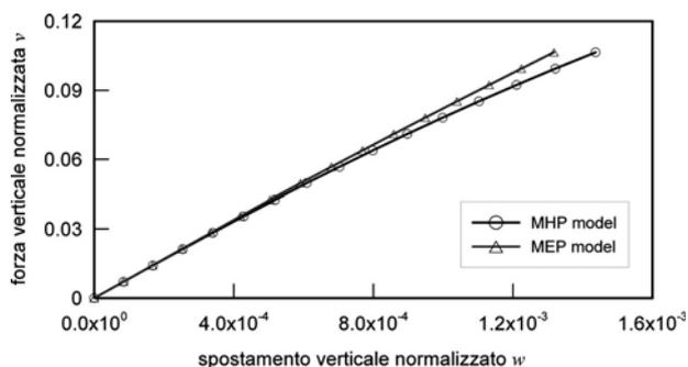
Fig. 11 – Prova di calibrazione n. 1 – fase a): forza verticale normalizzata  $v$  vs. spostamento verticale normalizzato  $w$ .
