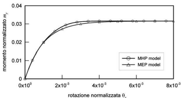
Fig. 13 – Prova di calibrazione n. 2 – fase b): momento normalizzato  $m_y$  vs. rotazione normalizzata  $\theta_y$ .
