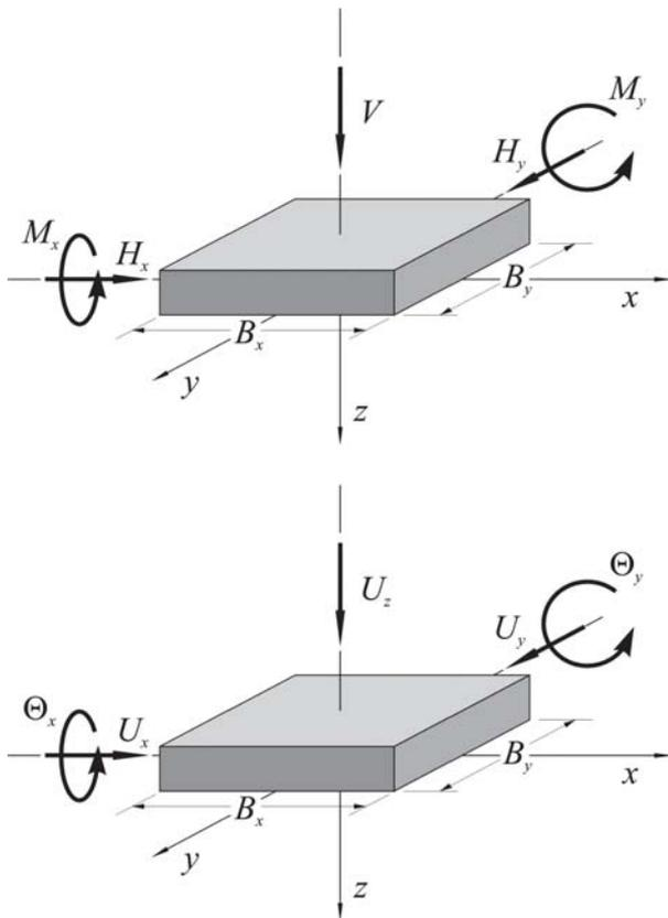
Fig. 1 – Componenti dei vettori  $T$  e  $U$ : a) forze generalizzate; b) spostamenti generalizzati.
