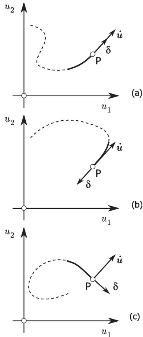
Fig. 2 – Effetto della storia degli spostamenti sulla risposta del sistema, per un assegnato stato di sollecitazione, al variare della direzione della velocità  $\dot{u}$ .
