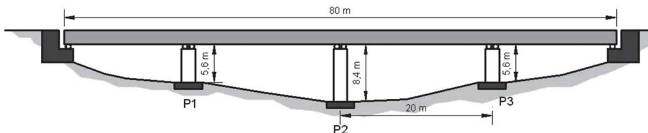
Fig. 6 – Schema del viadotto preso in esame (non in scala; le dimensioni riportate si riferiscono al prototipo in scala ridotta).
