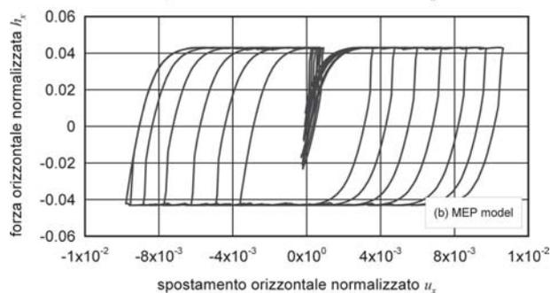
Fig. 14 – Prova di calibrazione n. 3 – fase b): forza orizzontale normalizzata  $h_x$  vs. spostamento orizzontale normalizzato  $u_x$ .
