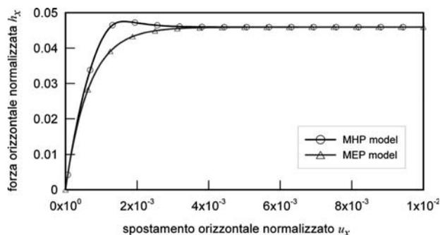
Fig. 12 – Prova di calibrazione n. 1 – fase b): forza orizzontale normalizzata  $h_x$  vs. spostamento orizzontale normalizzato  $u_x$ .
