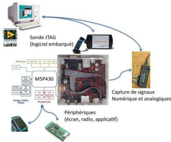
Fig 7 : Synoptique d'accès à distance des ressources
