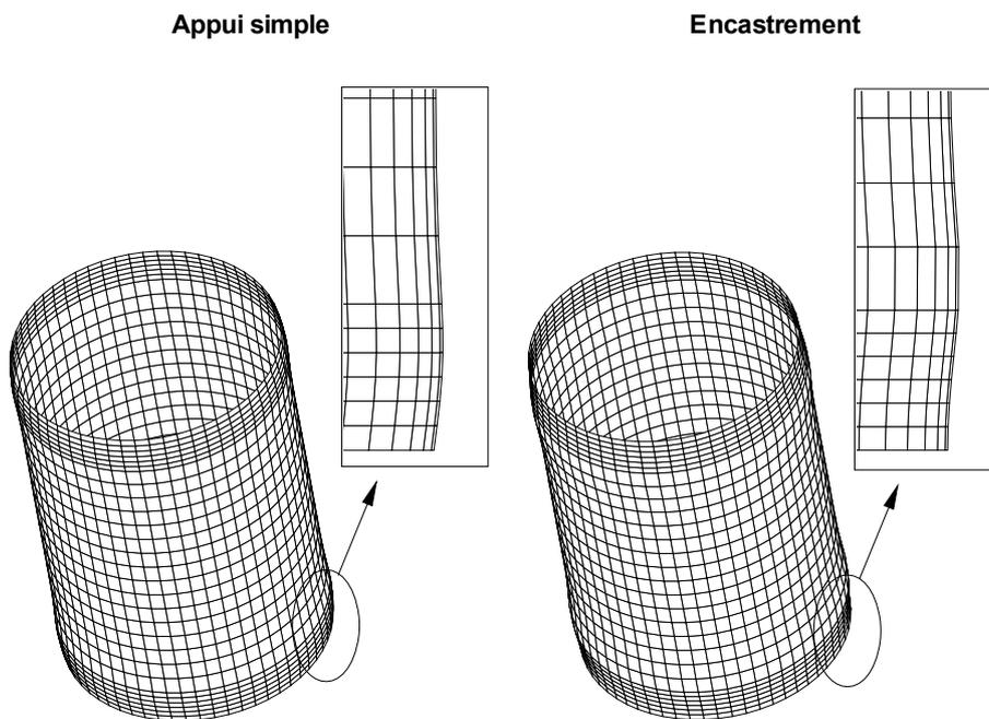
**Figure 4.** *Cylindre élastoplastique sous compression axiale : déformées axisymétriques*
