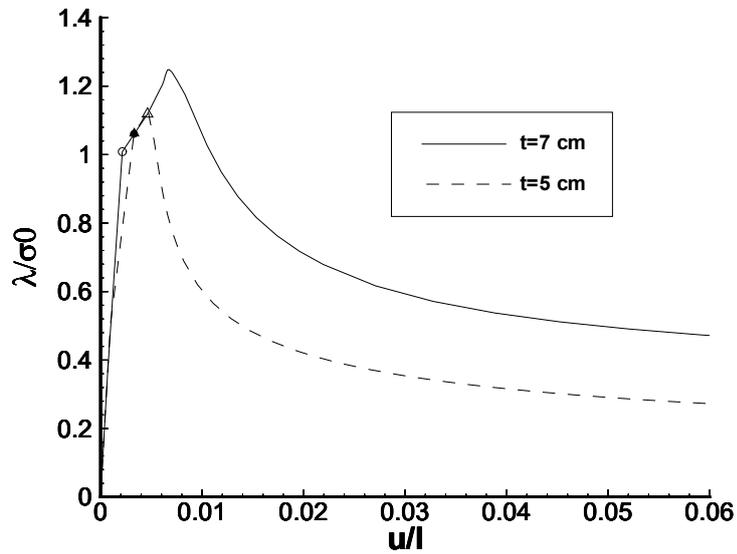
**Figure 9.** *Cylindre élastoplastique sous compression axiale (bords libres, forces imposées) : courbes contrainte de compression-raccourcissement axial ( $\circ, \bullet$  : début de plastification ;  $\Delta, \blacktriangle$  : bifurcation)*
