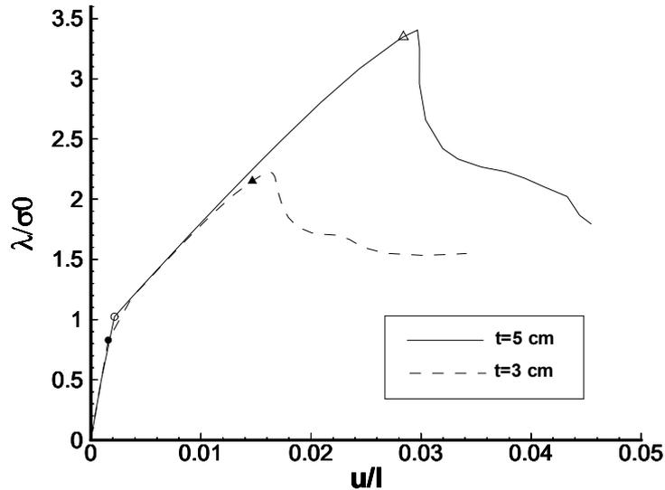
**Figure 11.** *Cylindre élastoplastique sous compression axiale (bords encastés, forces imposées) : courbes contrainte de compression-raccourcissement axial (○,● : début de plastification ; △,▲ : bifurcation)*
