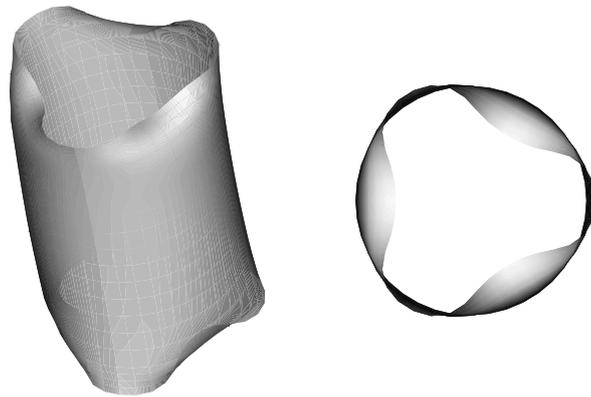
**Figure 6.** Cylindre élastoplastique sous compression axiale : bords libres, forces imposées,  $t = 7 cm$
