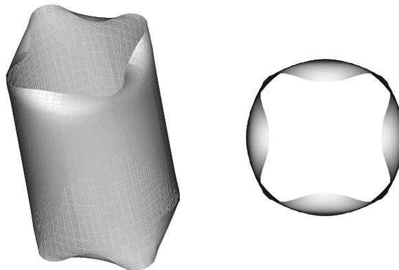
**Figure 8.** *Cylindre élastoplastique sous compression axiale : bords libres, forces imposées,  $t = 5 \text{ cm}$*
