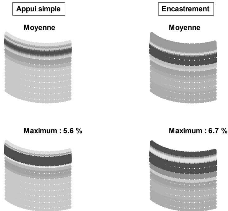
**Figure 5.** *Cylindre élastoplastique sous compression axiale : déformation plastique équivalente*
