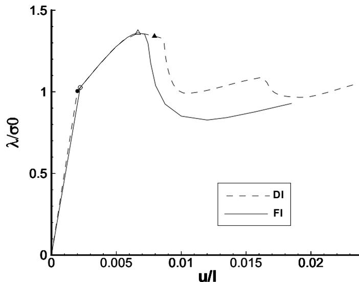
**Figure 14.** Cylindre élastoplastique sous compression axiale (bords appuyés,  $t = 2 \text{ cm}$ ) : courbes contrainte de compression-raccourcissement axial ( $\circ, \bullet$  : début de plastification ;  $\triangle, \blacktriangle$  : bifurcation ; FI : Forces imposées ; DI : Déplacements imposés)
