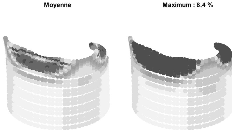
**Figure 7.** *Cylindre élastoplastique sous compression axiale : bords libres, forces imposées,  $t = 7 \text{ cm}$ , déformation plastique équivalente*
