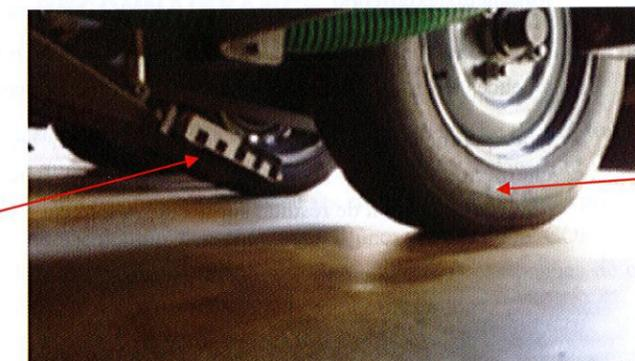
Goulotte de forme parallélépipédique déposant lors de l'essai un film d'eau d'un mm sous la roue de mesure.
