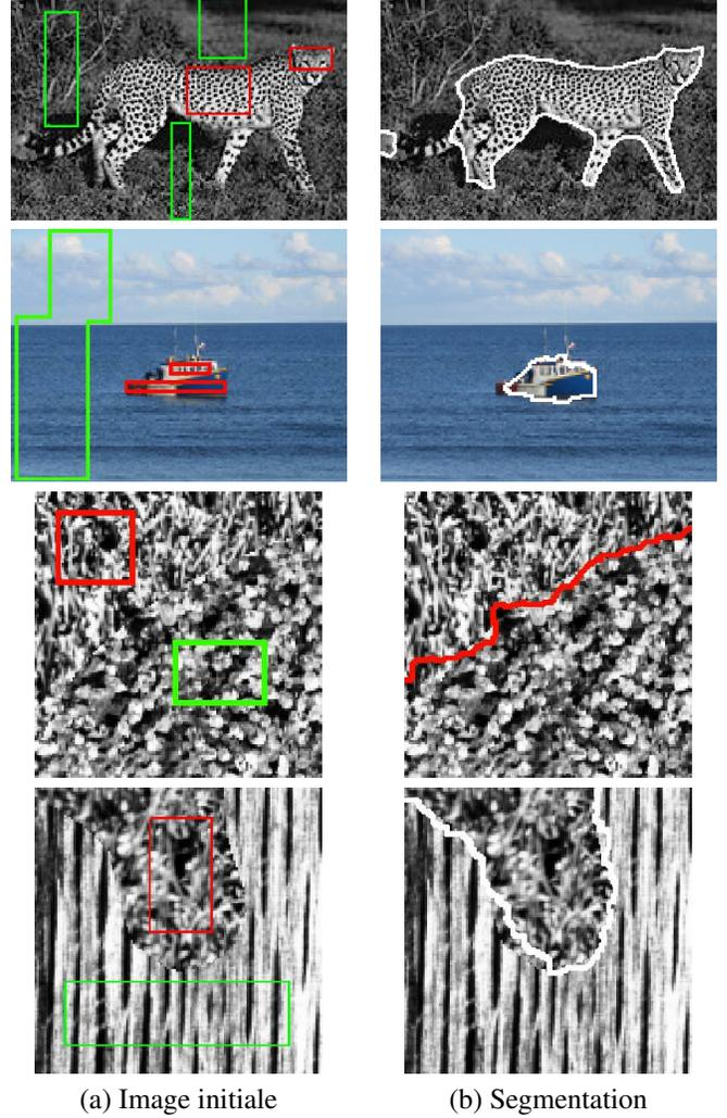
FIGURE 1 – Segmentations de quelques images avec  $\beta = 0.5$ . Les types d'histogrammes utilisés sont, de haut en bas : les niveaux de gris, la couleur, le tenseur de structure, les LBP. Les segmentations sont satisfaisantes, une modification du paramètre  $\beta$  permettrait d'améliorer la segmentation du navire [29].
