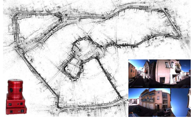
FIG. 2 – Caméra, trajectoire, nuage de points épars par SfM, et images de la séquence.
