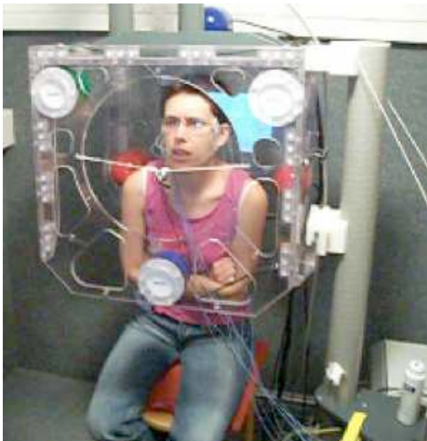
Figure 5: Electromagnetic articulography in a laboratory setup (Centre d'Expérimentation sur la Parole at LPL).
