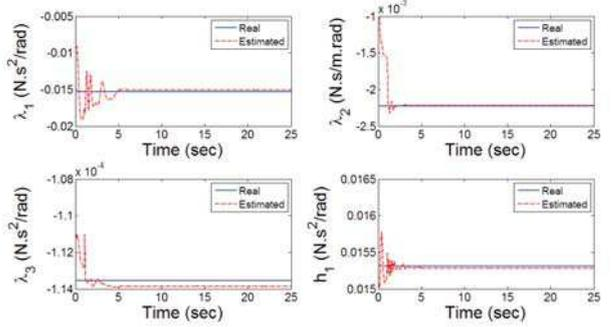
Fig. 7. Bank controller parameters estimation
