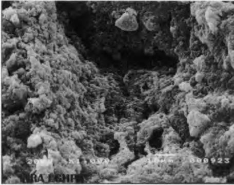
**Fig 4.** Photographie en microscopie électronique à balayage du joint C (chambrage) après 20 semaines d'utilisation, au niveau de la face exposée aux fluides.
