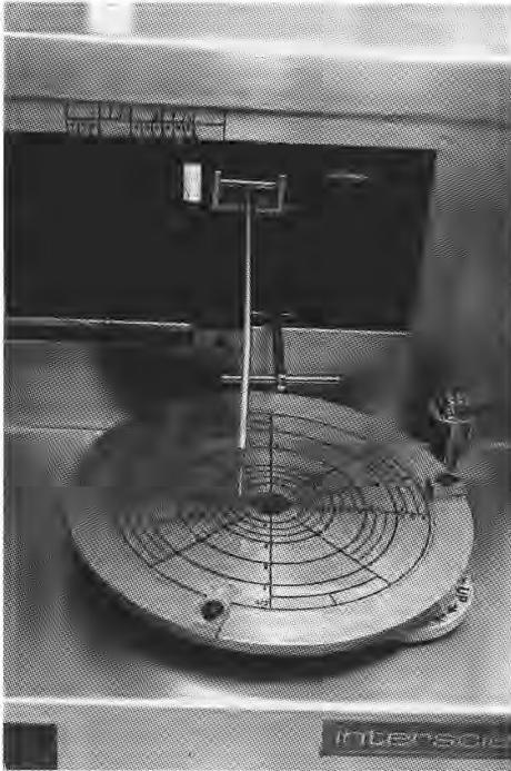
**Fig 2.** Vue de l'ensemenceur montrant la grille de comptage disposée sur le plateau, la bande de papier collée sur le carter de l'appareil et l'aiguille placée sur la partie mobile (en noir) de l'appareil portant le stylet.
