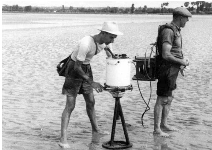
Fig. 7. Levers gravimétriques dans une zone littorale de la région Languedoc-Roussillon, en 1953. Document BRGM.
