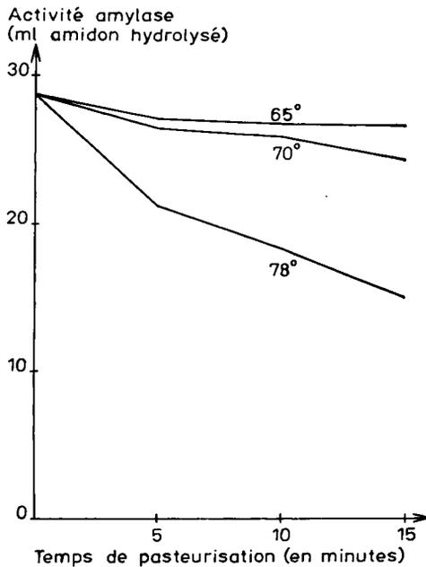
FIG. 3. -- Destruction de l'amylase par chauffage des miels de la série A/63
