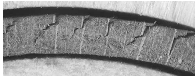
Fig. 4 Lateral view of checked beech veneer under the microscope Abb. 4 Mikroskopische Aufnahme von gerissenem Buchenfurnier. Seitenansicht
