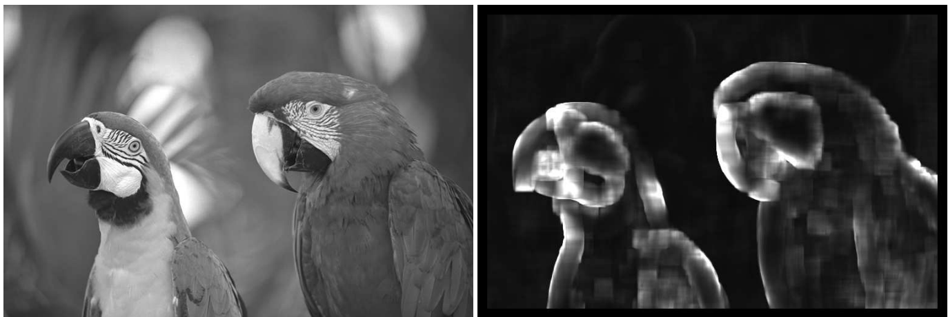
FIGURE 3 – À gauche : image Parrots . À droite, la carte de netteté locale. La valeur du pixel (x, y) correspond à la valeur de LSI sur la fenêtre [x - 16, x + 15] \times [y - 16, y + 15] de taille 32 \times 32 .
