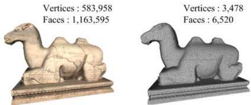
FIGURE 12 – À Gauche : le nuage de points initial (583.958 points). À droite : le nuage de points sous-échantillonné (3.478 points).
