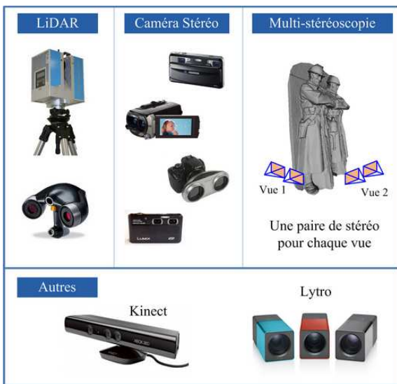
FIGURE 2 – Les systèmes d’acquisition “image avec 3D” : LiDAR, caméra stéréo, multi-stéréoscopie et autres systèmes.
