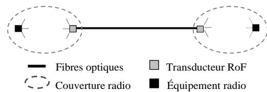
**Figure 3. Lien RoF point-à-point : le tunnel optique.**
